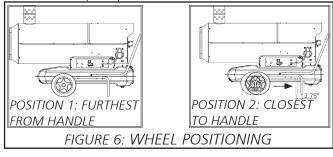
**WARNING:** BEFORE STARTING ANY MAINTENANCE ADJUST WHEELS TO POSITION 1
